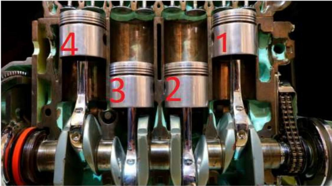
Anhand des Bilds kann man sehen daß beim 4 Zylinder Reihenmotor die Zylinder 1+4 und 2+3 parallel laufen.
